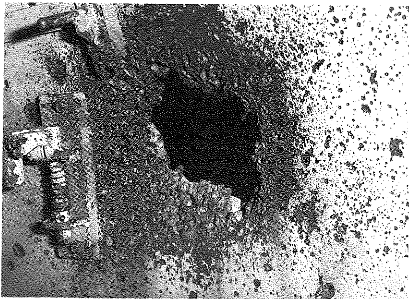
Bild 10: 15. Splitterfördelning runt utgångshålet från pansarprojektilen i bild 10: 14. Observera det stora antalet små splitter som avviker från de stora splittren
