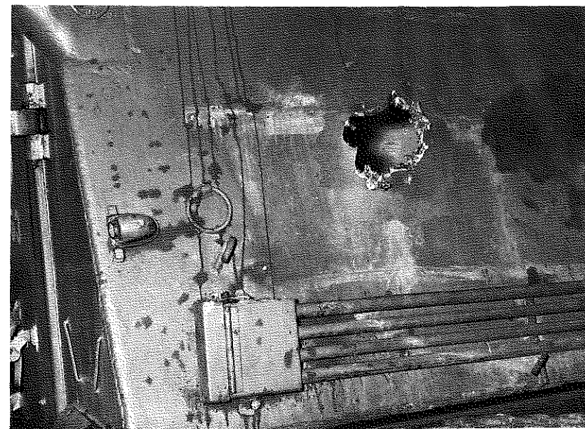
Bild 10: 16. Utsidan av utgångshålet efter pansarprojektilen i bild 10: 14 och 15
