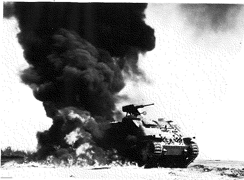
Bild 10: 17. Brand efter träff i yttre drivmedelstank
